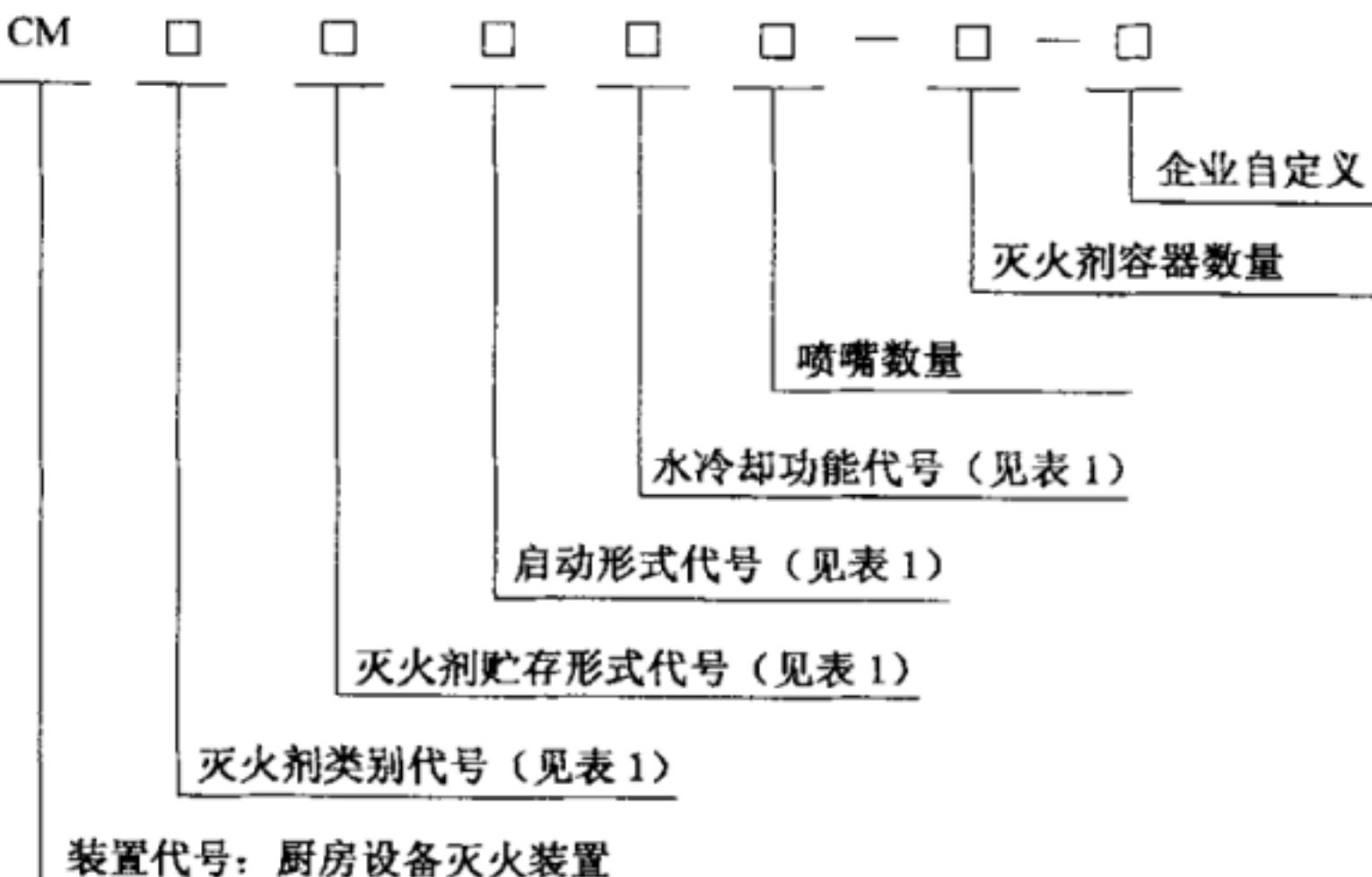
示例：CMZJS8-3，表示使用食用油专用灭火剂、贮压式、机械启动、具有水冷却功能、8只喷嘴、3个灭火剂容器的厨房设备灭火装置。
